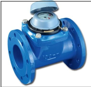
Woltmann orizzontale a tamburo estraibile. Orologeria sigillata a trascinamento magnetico a lettura diretta su rulli numeratori. Anello orientabile su 360°. Utilizzo per industria ed irrigazione. Predisposizione per dispositivo lancia impulsi (applicabile anche dopo installazione). Materiali di prima qualità resistenti alla corrosione.
